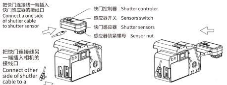
把感应器插到相机的接口端,顺时针旋转感应器锁紧螺母,使感应器固定在相机上
